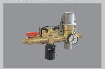
Für das Befüllen geschlossener Heizungsanlagen. Mit Rückflussverhinderer gemäß EN 1717. Der Systemtrenner mit kontrollierbaren, druckreduzierten Zonen Typ BA 1/2", zertifiziert nach EN 12729, verhindert, dass verschmutztes Wasser der geschlossenen Heizanlage in das Trinkwassernetz zurückfließen kann. Inkl. Wärmedämmschale.
