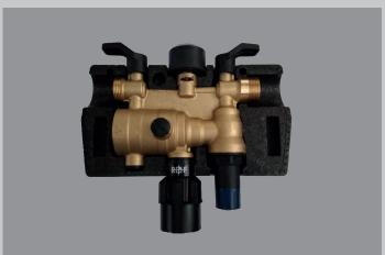
Zur automatischen Befüllung von geschlossenen Heizungsanlagen. Mit ein- und ausgangsseitiger Absperrung, Druckminderer, Manometer, Systemtrenner BA nach DIN EN 1717 bis einschließlich Flüssigkeitskategorie 4. Ausgangsdruck des Druckminderers regelbar von 1,5 bis 4 bar. Integrierter Schmutzfänger aus Nirogewebe. Inkl. Wärmedämmschale.
