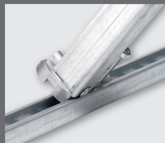
Leichte Befestigung durch Einsetzen in C-Schienen mit dem Maß: 27 x 18 mm und der Profillöffnung von 15 mm
