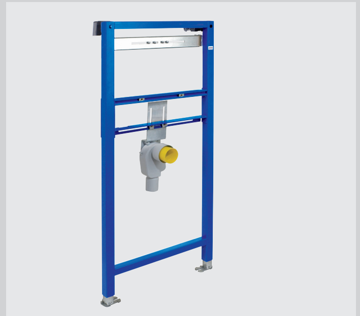
Waschtisch-Trockenbauelement für Wandarmatur, mit UP-Geruchverschluss für barrierefreies Bauen, Bauhöhe 1120 mm, inkl. Wandhalter – Montageplatte zur Aufnahme der Wasseranschlüsse Art.-Nr. 30 470 03 112 000
