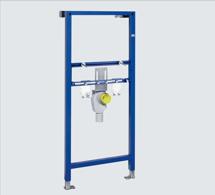
Waschtisch-Trockenbauelement für Einlochbatterie, mit UP-Geruchverschluss für barrierefreies Bauen, Bauhöhe 1120 mm, inkl. Wandhalter – tiefenverstellbare Montageplatte zur Aufnahme der Wasseranschlüsse Art.-Nr. 30 470 02 112 000
